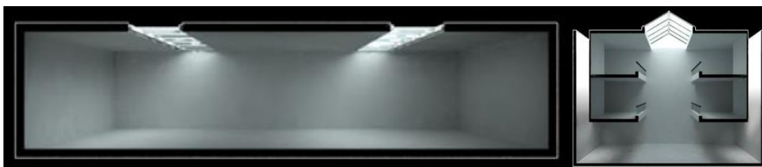
Imagem 07 – Claraboia, superfície iluminante em posição horizontal, o que requer maior manutenção. Imagem 08 – Atrio, espaço central de uma edificação aberto na cobertura. Na foto, exemplo de tudo reflexivo para a captação de luz em conjunto com o átrio. – Fonte: Iluminação e Arquitetura – Vianna, Nelson Solano Gonçalves, Joana Carla S.
