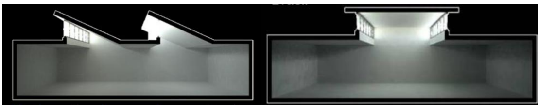
Imagem 05 – Sheds, no Brasil, apresentam um melhor desempenho quando orientados a sul para latitudes compreendidas entre 24° e 32°S. Imagem 06 – Lanternins, são duas faces opostas e iluminantes. No Brasil sua melhor orientação é N-S. – Fonte: Iluminação e Arquitetura – Vianna, Nelson Solano Gonçalves, Joana Carla S.
