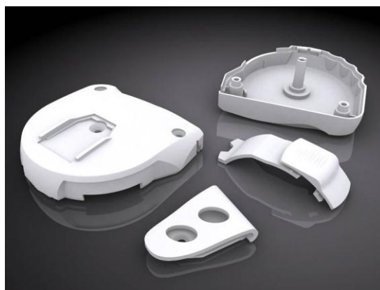
Figura 12: Peças produzidas pelo processo de prototipagem rápida utilizando a tecnologia de Sinterização Seletiva a Laser (SLS, Selective Laser Sintering) 9 , 2008. Fonte: Ilustração do próprio autor.
